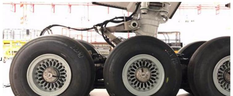
mais un pneu d'avion à réaction commercial est bon pour environ 250 atterrissages.
